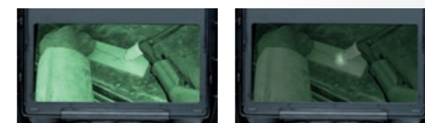
Torcia e filo d'apporto, in posizione ottimale
