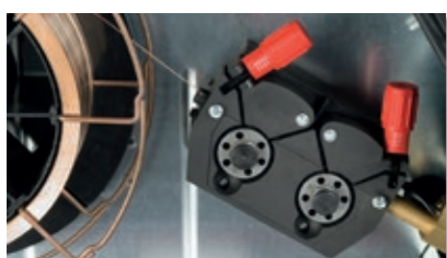
Alimentazione filo di qualità con 4 rulli
